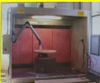
Sistemas y Cabinas para Líquidos Penetrantes: automáticos, Semiautomático y manual
